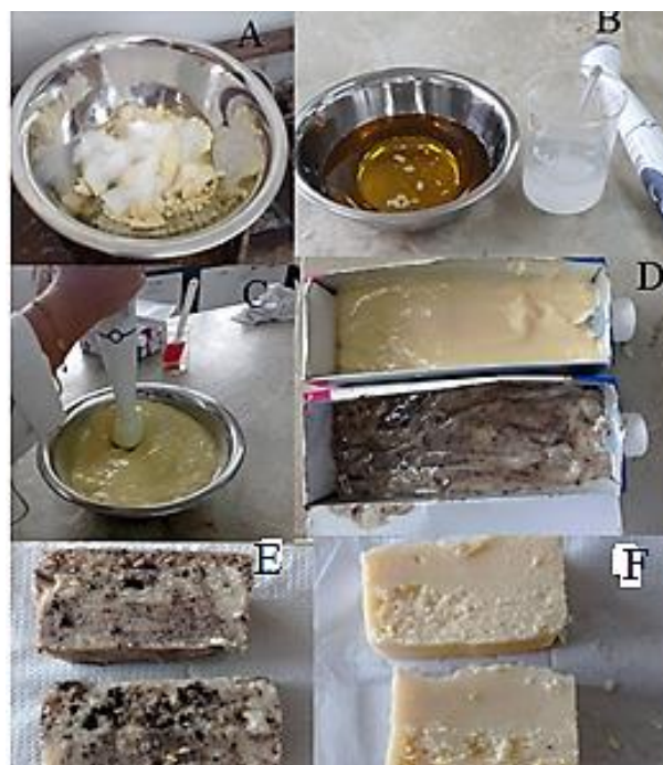
A: óleos e manteigas em banho-maria; B: solução de hidróxido de sódio; C: processo de homogeneização e obtenção do “Trace”; D: sabonetes nas formas; E: sabonete esfoliante; F: sabonete normal
